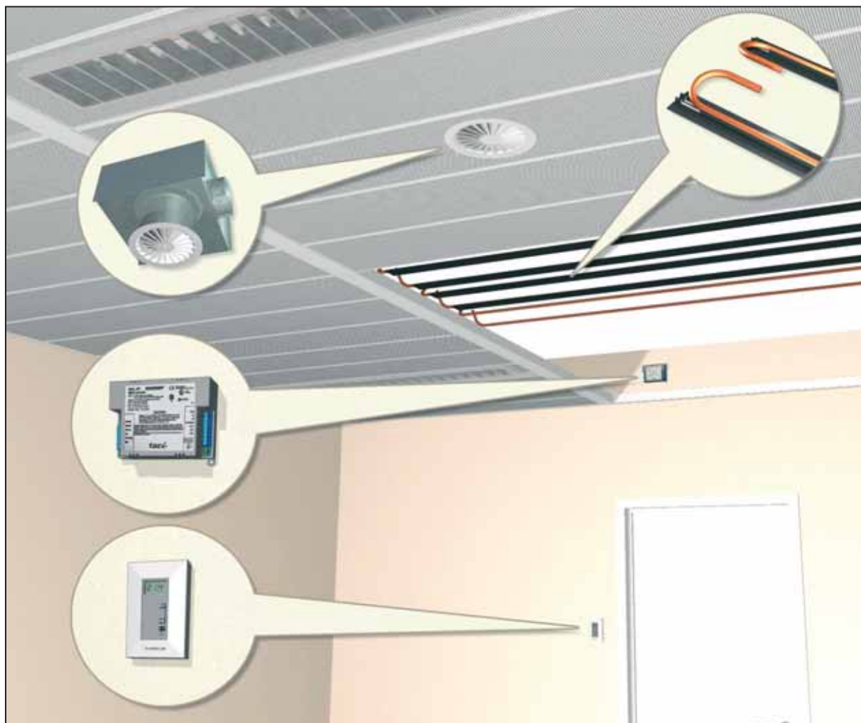
Integrale samenwerking van klimaatplafond, regeltechniek en luchtverdeeltechniek
