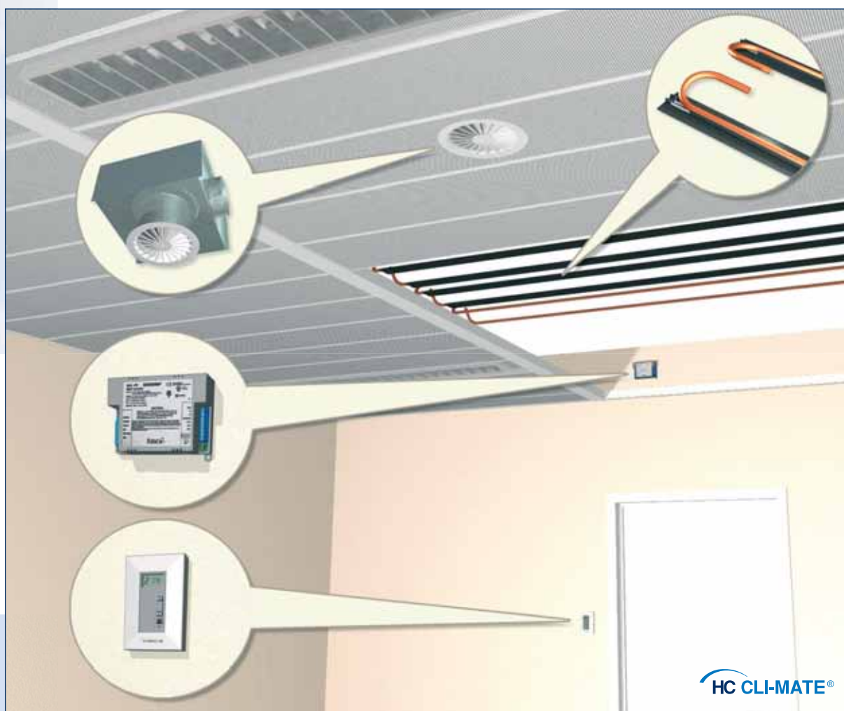
Integrale samenwerking van klimaatplafond, regeltechniek en luchtverdeeltechniek
